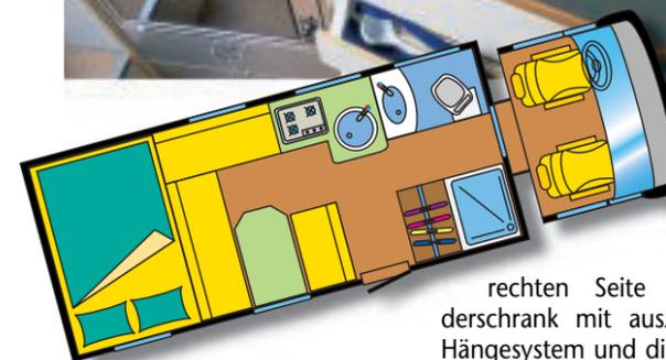
kasten – er ist mit einer außen hängenden und zwei innen liegenden Trittstufen ausgeführt – steht der Küchenblock mit Dreiflammkocher, Backofen, Spüle, Mülleimer und insgesamt sechs auf Vollauszügen laufenden Schubladen. Vor dem Einstieg sind auf der
