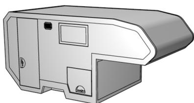
Die Form A vermittelt durch den separaten Schlafbereich über dem Führerhaus ein geräumiges Wohngefühl. Dadurch nutzt die Kabine die Aufbaufläche des Fahrgestells optimal, was jedoch zu einem höheren Schwerpunkt führt. Die Geländetauglichkeit wird dadurch eingeschränkt.
